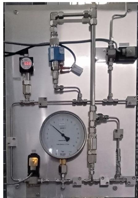
Après l'enrichissement en hélium, l'eau est réintroduite dans le réseau. L'hélium s'échappe des éventuelles fuites et peut être détecté au moyen d'appareils de mesure manuels.
