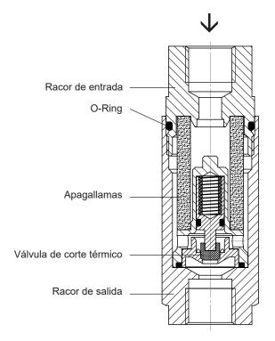
Dispositivos de seguridad F53N/HHO de WITT ofrecen protección fiable contra retrocesos de llama peligrosos para el uso de mezclas de hidrógeno y oxígeno.
