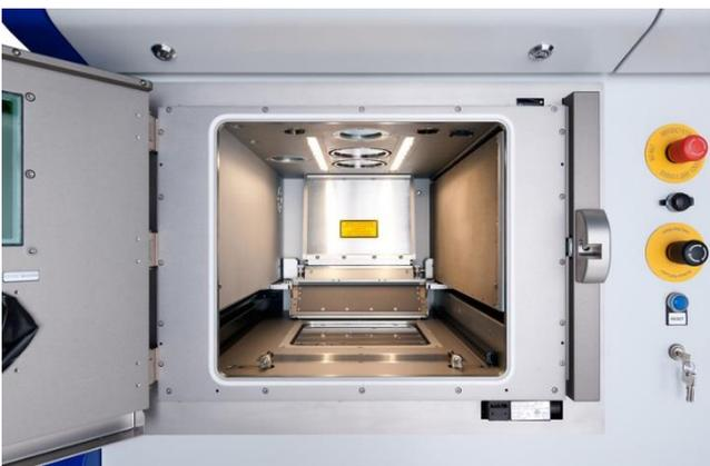
*Prozesskammer der Selective Laser Melting Maschine SLM280 2.0 der SLM Solutions Group AG*
