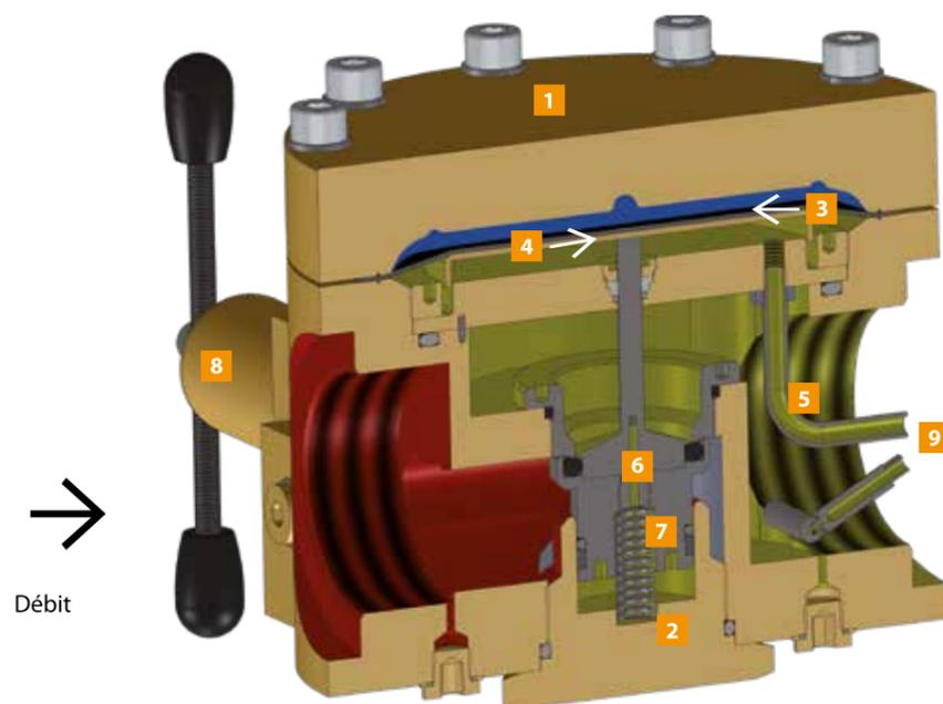
■ Pression d'entrée ■ Pression de pilotage dans la chambre de pression ■ Pression de sortie
