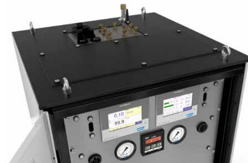
Le MED-MG est équipé avec des dispositifs de sécurité fonctionnant en parallèle pour assurer la plus haute fiabilité. Si un de ces composants détecte un dysfonctionnement et déclenche une alarme, les électrovannes en sortie du mélangeur et la sortie du réservoir se ferment et la fourniture d'air synthétique est interrompue. Dans ce cas, les appareils envoient des signaux qui peuvent activer un système de secours parallèle.
