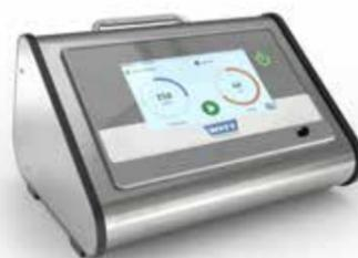
Le LEAK-MASTER® EASY permet la détection des plus petites fuites sans recourir aux gaz traceurs. Le principe repose sur une méthode bien connue et intuitive de détection des fuites : la visualisation de bulles d'air dans l'eau. L'emballage à tester est placé dans une chambre remplie d'eau et maintenu sous l'eau par une plaque transparente.
